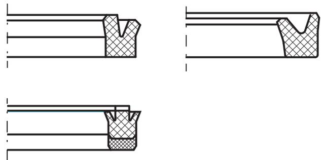
Fanno parte delle guarnizioni di tenuta a labbro anche le guarnizioni multiple a pacco. Con queste guarnizioni multiple si presentano altre condizioni d'attrito e di forze, provocate dalla costruzione a più labbri e da una lunghezza maggiore della guarnizione.
