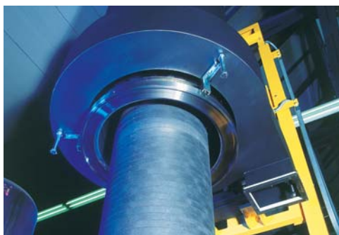
Guarnizioni in grafite per reattori a temperature elevate
