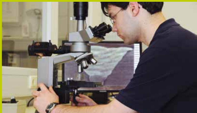
Controllo del cordone di saldatura al microscopio
