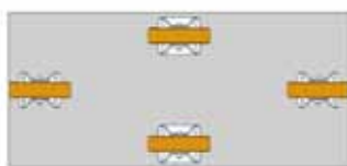
Quattro ruote con supporto fisso, quelle centrali hanno un'altezza leggermente maggiore
