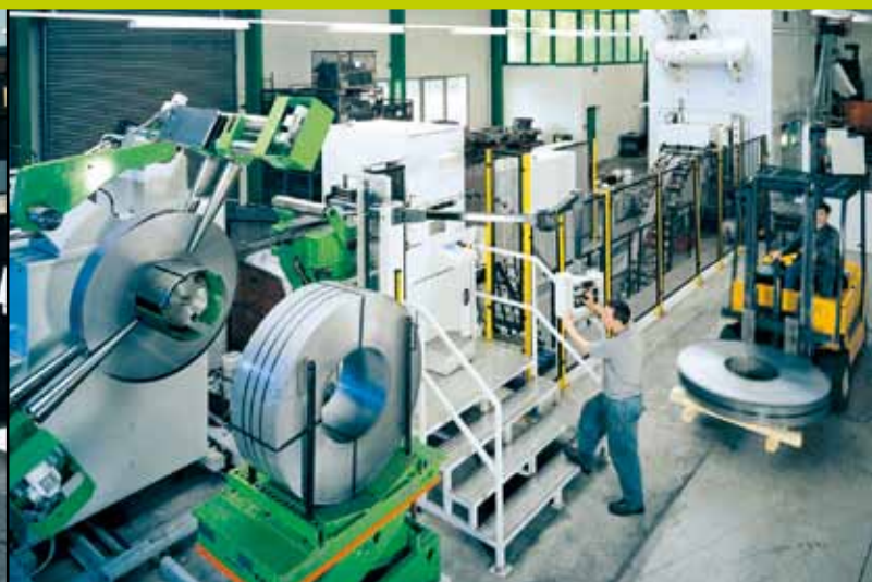
Forza concentrata: il parco di presse moderno con una pressione di stampaggio fino a 630 tonnellate
