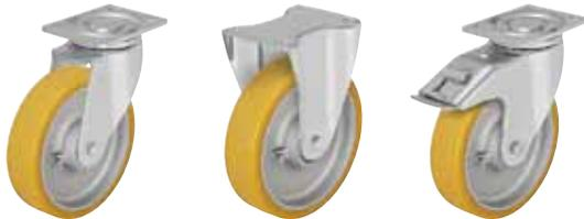
**Supporti:** Serie LH/BH - In lamiera d'acciaio stampata molto spessa, supporto girevole con forcella e piastra rinforzate, perno centrale ad alta resistenza avvitato e bloccato, con doppio cuscinetto a sfere nel gruppo rotante, ulteriormente rinforzato da **quattro calotte temprate dalla forma speciale** e quindi particolarmente insensibile agli urti ed alle vibrazioni.
