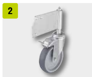
2 Ruota con supporto istituzionale girevole con fissaggio speciale e sospensione integrata nel codolo.
