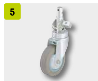
5 Ruota con supporto girevole con sistema di bloccaggio centrale della ruota, del gruppo rotante e direzionale, cuscinetto speciale nel gruppo rotante ed anello antitraccia.
