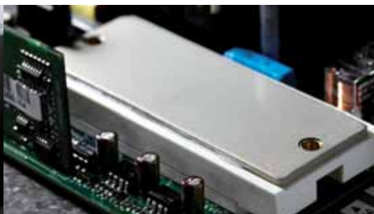
Controllo integrato del calore degli IGBT.
