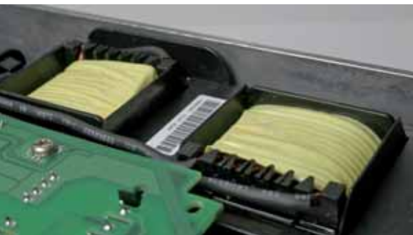
Le bobine DC riducono la distorsione armonica e proteggono l'inverter.
