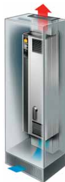
Un kit intelligente e appositamente dedicato, fa sì che i contenitori D1 e D2 possano essere montati in quadri Rittal, cosicché l'aria di raffreddamento rimuove l'85% del calore in eccesso senza interessare la parte elettronica.
