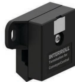
La piccola cassetta di terminazione funge da resistenza terminale per il cavo di comunicazione del sistema ConveyorControl. La cassetta di terminazione può essere messa facilmente in contatto con il cavo tramite tecnica "piercing" (a perforazione).
