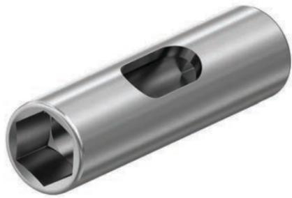
L'adattatore di fissaggio serve a serrare il dado di fissaggio del RollerDrive alla corretta coppia di serraggio con una chiave dinamometrica. L'adattatore è provvisto di un'apertura laterale per far passare il cavo di collegamento RollerDrive.
