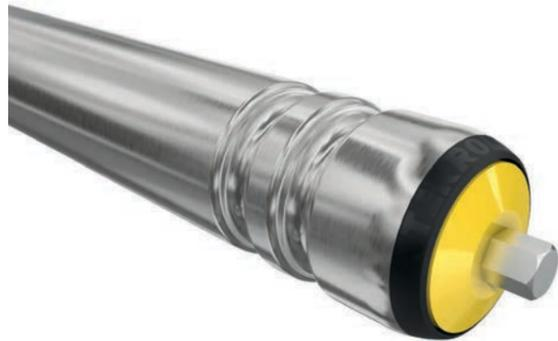
Le nervature sono gole di scorrimento che possono essere inserite in tubi in acciaio o in alluminio e fungono da guida delle cinghie tonde. In caso di utilizzo di adeguate cinghie tonde, le cinghie rimangono al di sotto della superficie del rullo e, quindi, non entrano in contatto con il materiale trasportato.
