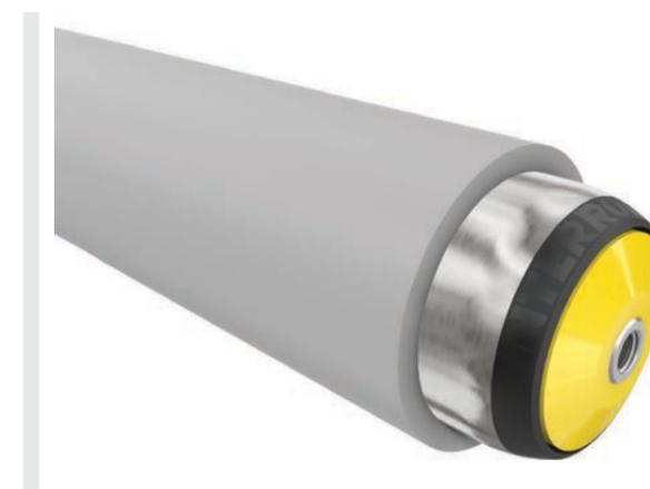
La guaina in PVC consente uno smorzamento particolarmente elevato del rumore e offre un'elevata protezione per i carichi delicati. Grazie al coefficiente di attrito superiore rispetto a un tubo in acciaio, si ottiene un trascinarsi migliore dei carichi. I carichi possono essere singolarizzati facilmente, poiché il diametro maggiorato permette una maggiore velocità a parità di numero di giri.
