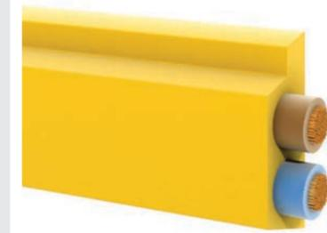
Il cavo piatto serve alla comunicazione del sistema di unità di controllo ConveyorControl. Le diverse unità di controllo del sistema entrano in contatto con il cavo semplicemente tramite contatti piercing. Il bordo esterno del cavo è conforme allo standard AS-Interface. La guaina del cavo sigilla i fori creati dai contatti piercing. In pratica, il cavo conserva il grado di protezione anche dopo aver scollegato l'unità di controllo.
