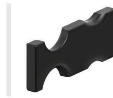
Il dispositivo di tensionamento PolyVee permette di tendere con facilità le cinghie PolyVee a 2 e 3 nervature ed è pensato per passi fra i rulli di 75 mm e 100 mm. Il dispositivo di tensionamento è progettato per rulli e RollerDrive con un diametro di 50 mm. Non può essere utilizzato con i tubi dotati di guaina di rivestimento o con elementi conici.
