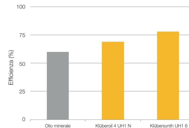
Dati ottenuti su banco prova Klüber per vite senza fine, con n1=350 rpm, N2=300Nm; i=1:39; a=63 mm; durata 300 h.
