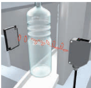
Utilizzo dell'effetto a doppia riflessione nel PET per la massima stabilità di rilevamento (modelli ottimizzati per PET)
