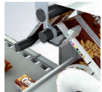
Rilevamento affidabile di tacche standard o semitrasparenti a velocità normale o elevata
