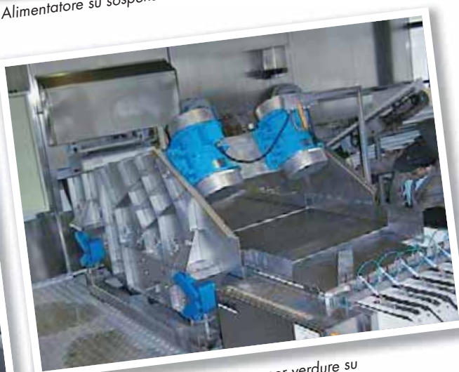
Canale di lavaggio e sgrondatura per verdure, su sospensioni tipo AB
