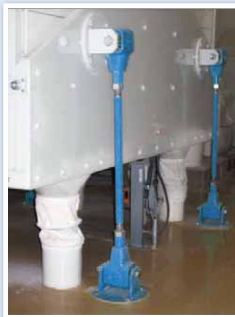
Vaglio circolare per il settore molitorio, su 8 sospensioni AV 38
