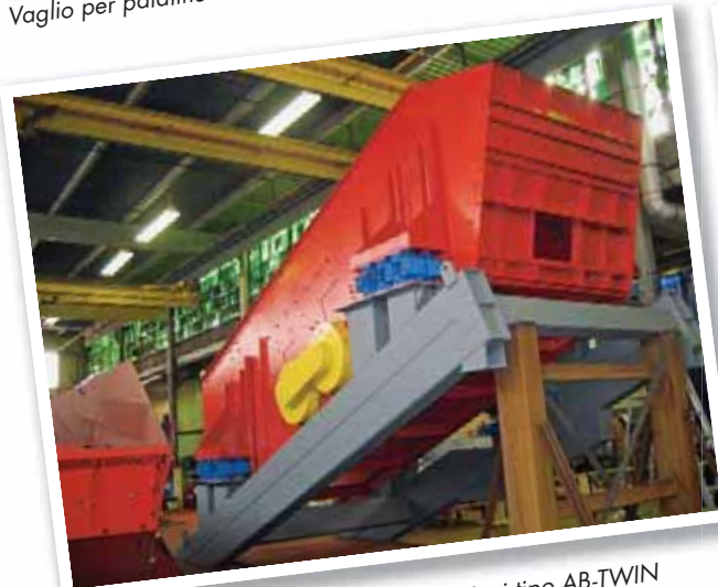
Vaglio per patatine su sospensioni tipo AB in acciaio Inox
