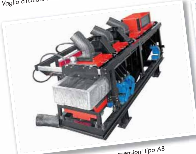
Canale per cemento su sospensioni tipo AB in configurazione pivot
