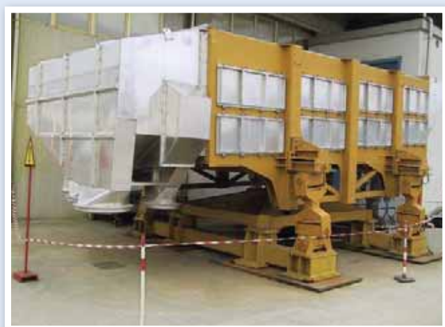
Vaglio circolare per truciolare, su giunti articolati AK 100-4
