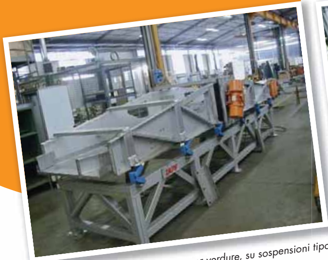
Alimentatore su sospensioni tipo AB in acciaio Inox
