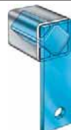
Fig. 18 Profilo quadro saldato ad una leva
