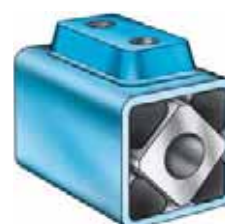
Fig. 6 Attacco filettato, saldato al corpo
