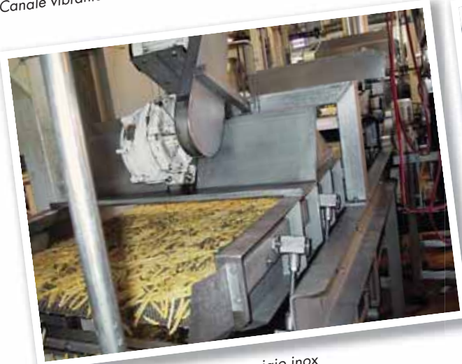
Canale vibrante con bracci in acciaio inox
