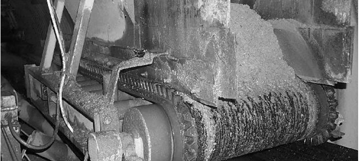
Lavorazione di inerti derivati dal mare, ambiente umido, salino ed aggressivo! La tenuta IP66/67 è un MUST, spesso anche con tenute reingrassabili!
