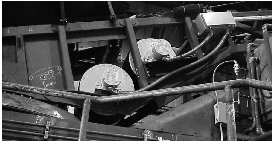
Scavatrice in cementeria negli Stati Uniti. Due mototamburi tipo 800H muovono entrambi i convogliatori di carico e scarico.
