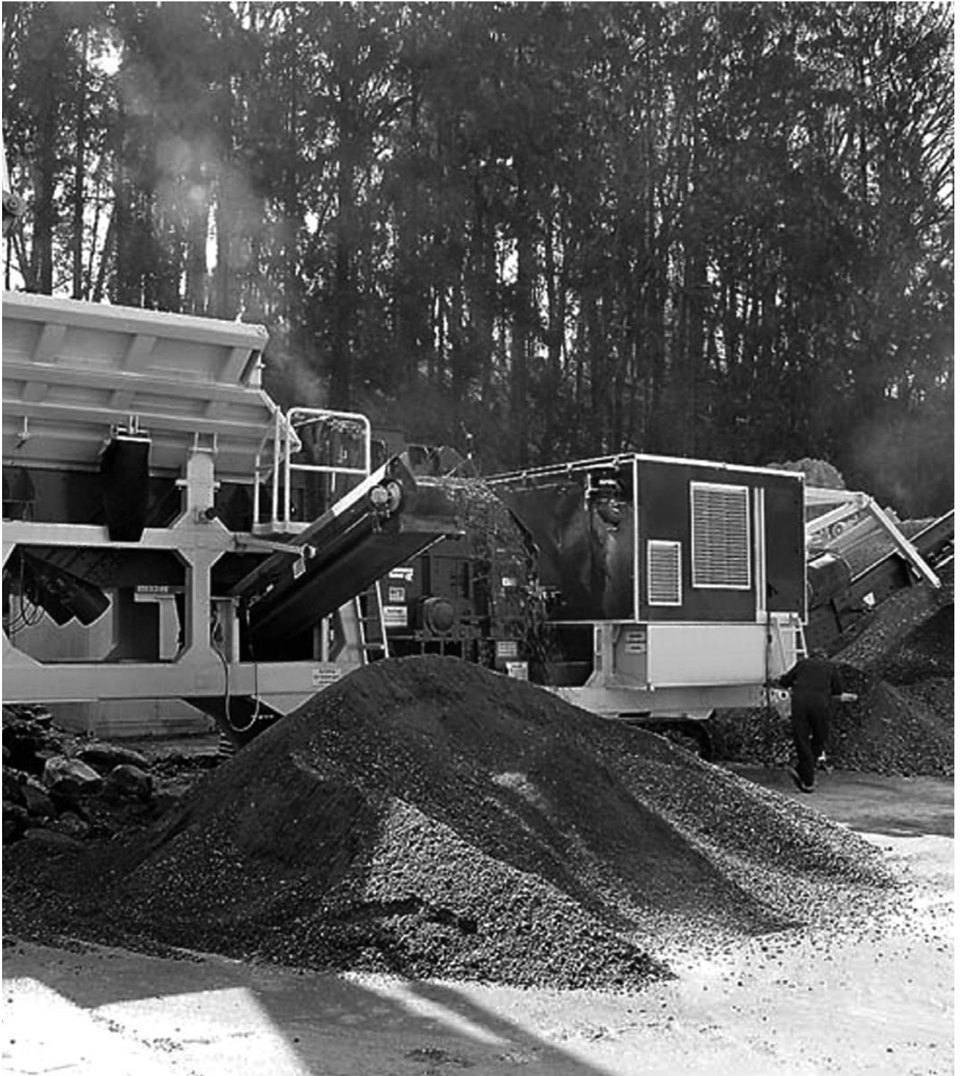
Mototamburi utilizzati in una macchina mobile per la frantumazione e setacciatura. Vantaggi: motorizzazione compatta, con peso centrato, affidabile e SENZA necessità di manutenzione.
