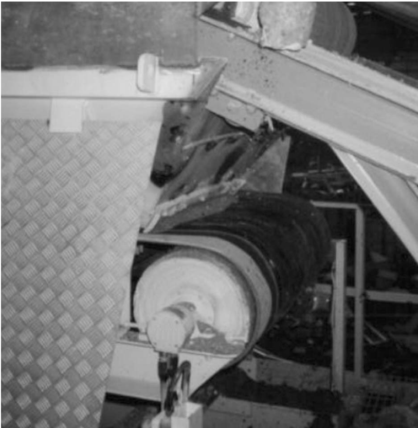
Applicazione nel riciclaggio: grazie al sistema di tenuta IP66/67 evita danni derivanti da ambienti aggressivi in presenza di alta acidità.
