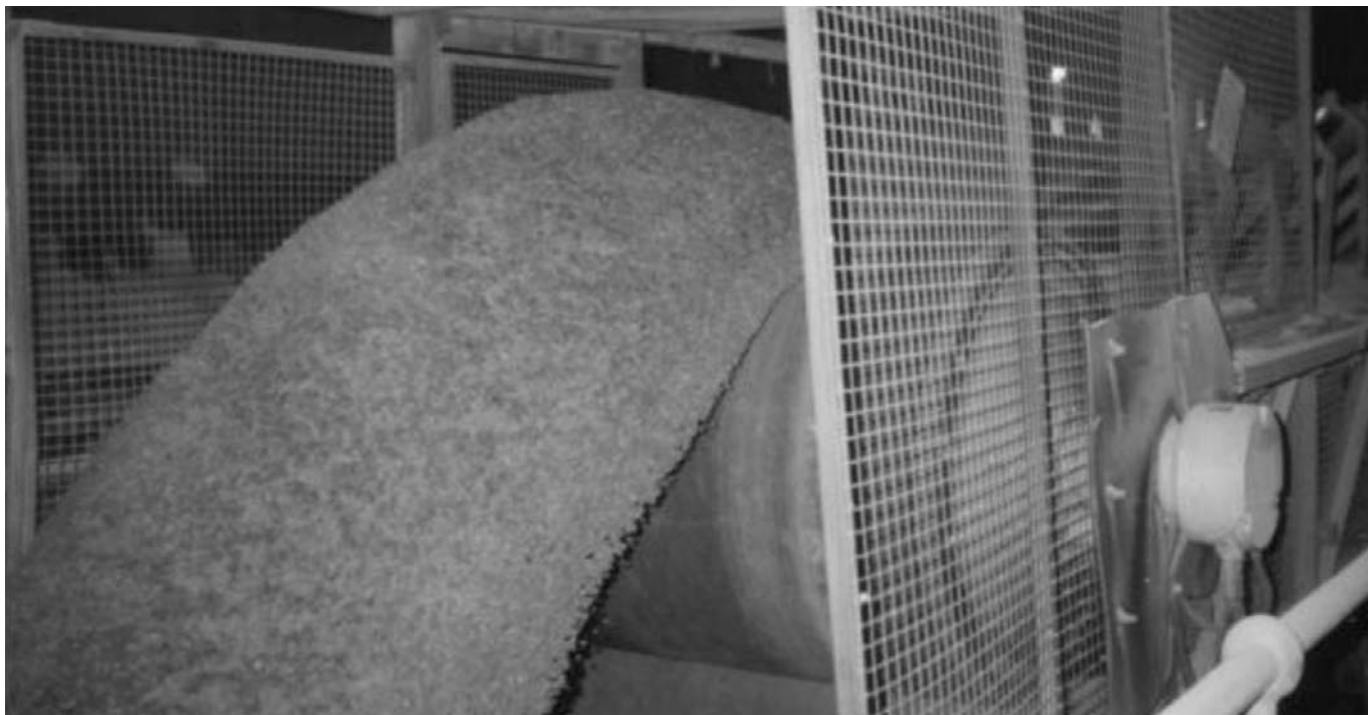
Mototamburi su convogliatore reversibile. Applicazione: granito frantumato. 5 milioni di tonnellate all'anno passano da questo sistema.
