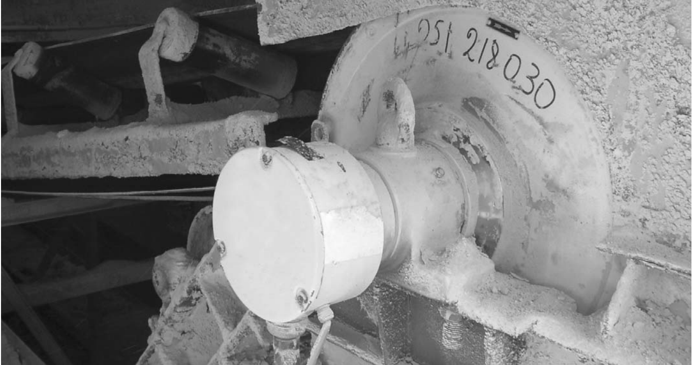
Trasporto di potassa, aggressiva ed abrasiva. Caratteristiche del mototamburo: tenute re-ingrassabili IP66/67, classe isolamento H, NESSUNA manutenzione e funzionamento con convertitori di frequenza.
