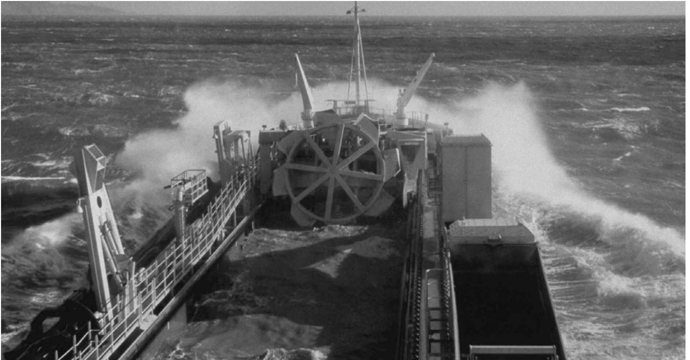
Draga al largo del Mare del Nord con piena e rapida capacità di scarico ad ogni porto per far fronte al cambio delle maree. Capacità: 2700 t/ora fino a 3.15 m/s di velocità.
