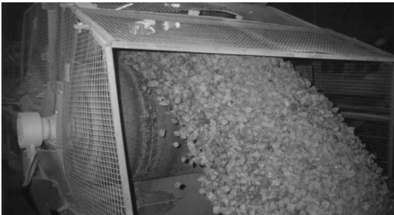
Convogliatore reversibile a doppia motorizzazione con due mototamburi 800M, 37.0 kW.
