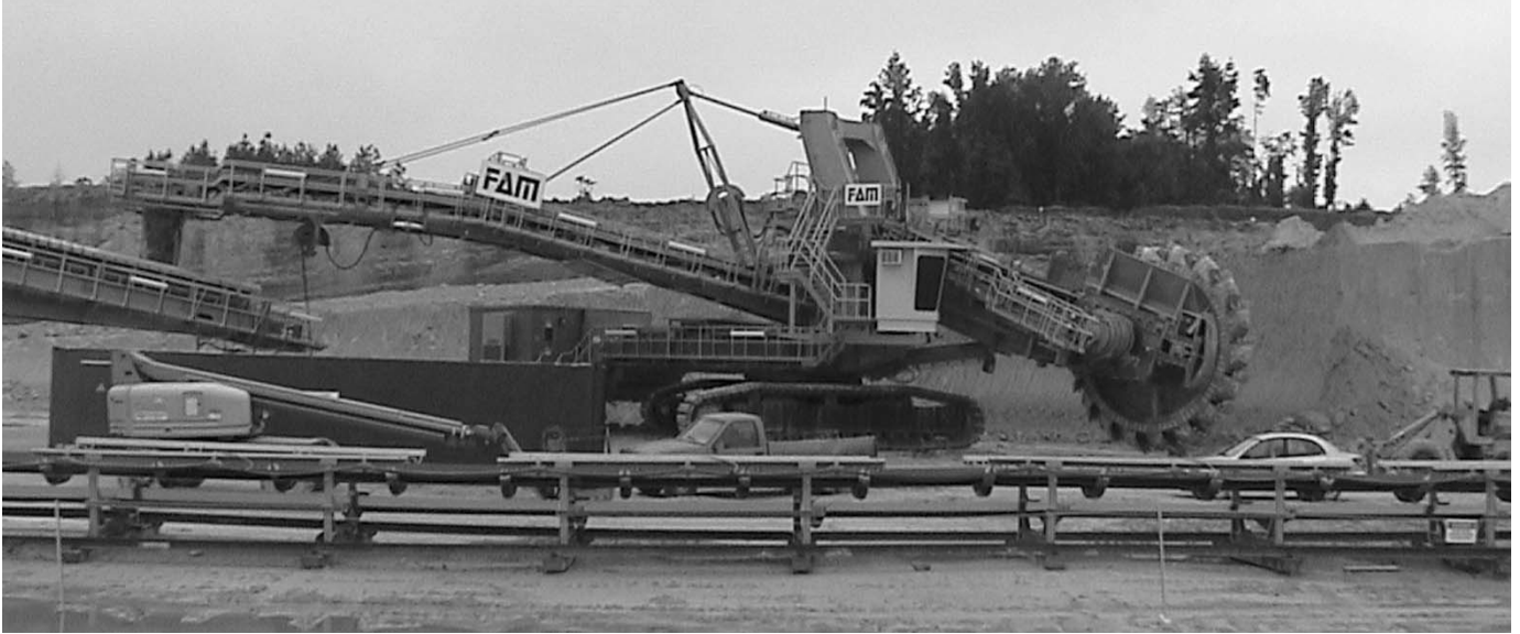
Scavatrice in cementeria negli Stati Uniti. Due mototamburi tipo 800H muovono entrambi i convogliatori di carico e scarico.
