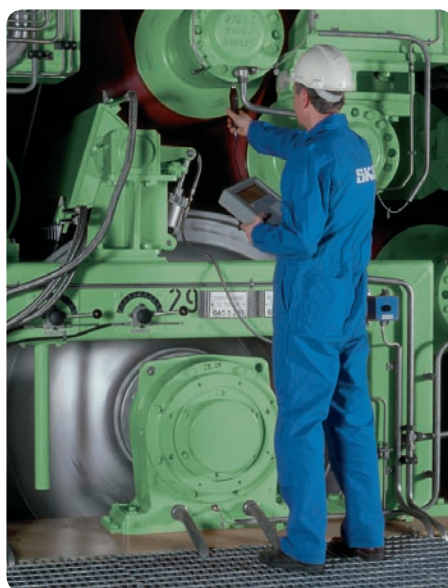
Rilevamento dei livelli di vibrazione
