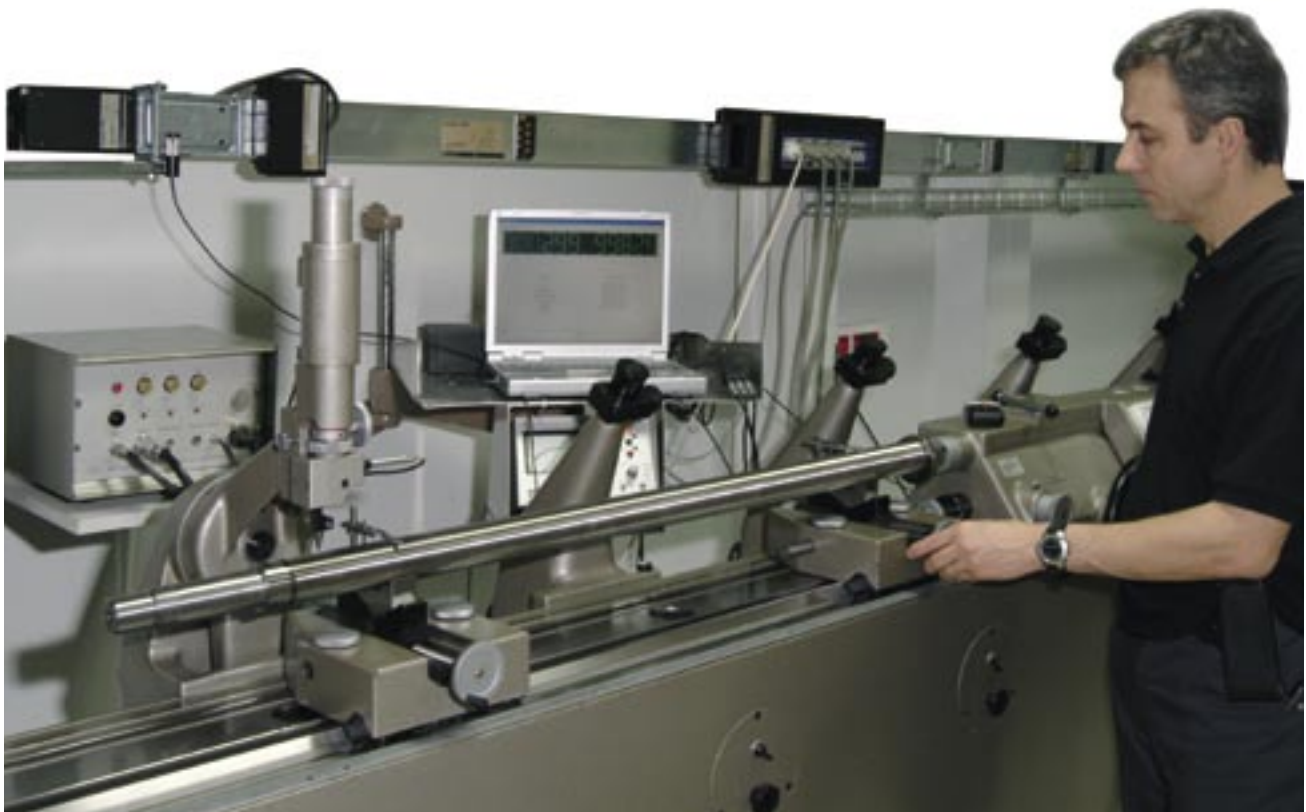
Banco di misura dell'errore di passo tramite interferometro
