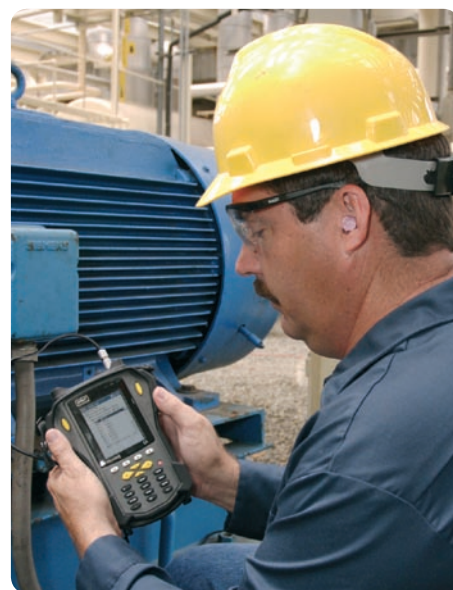
Registrazione di valori di vibrazione mediante un dispositivo per la raccolta dati della serie SKF Microlog
