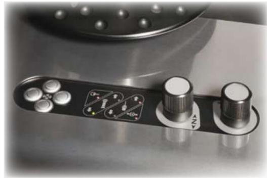
I movimenti degli assi sono servocontrollati con motori passo/passo e dispongono di due modalità: rapido (2,5 mt/min) e micrometrico (accuratezza posizionamento 0,8 µm).
