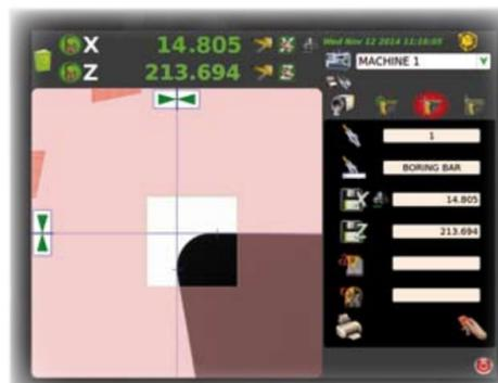
Nuova elettronica di gestione: un potente PC industriale fanless con sistema operativo Linux, per la gestione integrata delle funzioni di misura/ispezione utensili, origini macchina e toolsets. Utilizzo semplificato grazie allo schermo touch-screen integrato.
