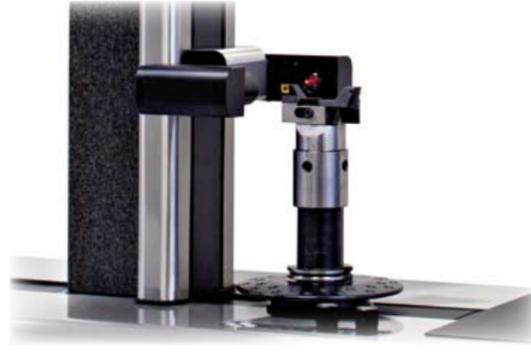
Sistema telecamera per le misure con illuminatore puntiforme e l'ispezione con illuminatore toroidale. Sensore C-MOS. Ottiche telecentriche a basso F/Number.
