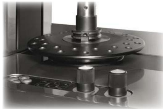
I movimenti micrometrici (volantini elettronici), sono utilizzati per la collimazione del profilo utensile e l'acquisizione della misura. La macchina è dotata di un sistema di recupero gioco brevettato.
