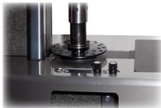
Granito naturale impiegato sia per la colonna sia per la base. La stabilità termica di questo materiale, permette di collocare la macchina in officina. La meccanica è realizzata con impiego di acciaio inox.
