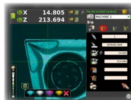
Funzione di ispezione per un controllo accurato dello stato dell'utensile. Possibilità di aumentare o diminuire l'intensità luminosa per una migliore visibilità. Sono presenti 4 differenti filtri colore che permettono di risaltare le difettosità dell'utensile.
