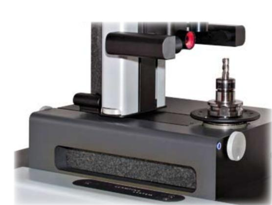
La base e la colonna, realizzati in granito naturale, sono di dimensioni adeguate al fine di garantire la massima precisione. Il coefficiente di dilatazione termica del materiale naturale permette di collocare la macchina preset direttamente in officina.
