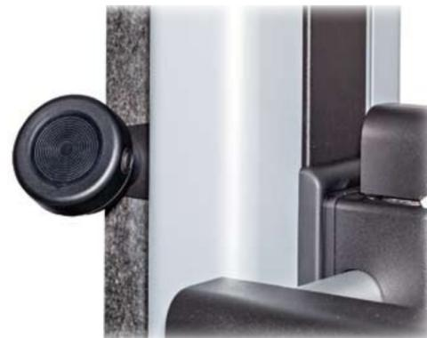
La forma ergonomica dell'impugnatura di movimentazione manuale assi permette di lavorare senza affaticarsi. Lo sblocco simultaneo degli assi, è attivato da un singolo pulsante. Il funzionamento del blocco/sblocco assi è di tipo pneumatico. Sono stati progettati dei settori dentati in bronzo che agiscono sulle viti al fine di ottenere alta precisione della micro registrazione.
