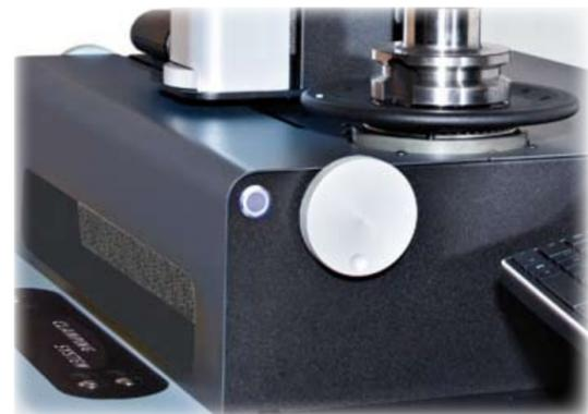
Gli spostamenti micrometrici degli assi sono realizzati, per l'asse X con due manopole poste a destra e a sinistra della macchina; per l'asse Z con una posta alla base della colonna. Le regolazioni micrometriche sono indispensabili per la collimazione dei taglienti degli utensili.
