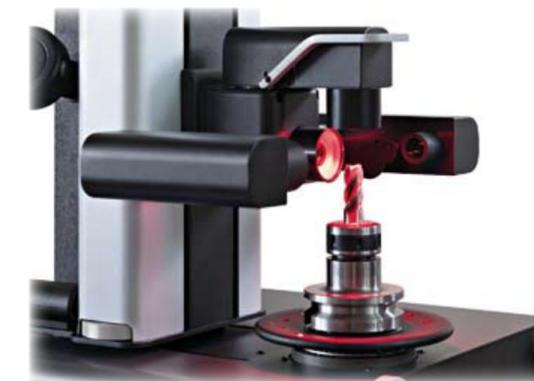
*Il nuovo E46LTW è equipaggiato con tre telecamere per la visione frontale (testa) e laterale (petto) dell'utensile. Il sistema consente a costruttori e riaffilatori di utensili la misurazione di tutte le caratteristiche geometriche dell'utensile.*
