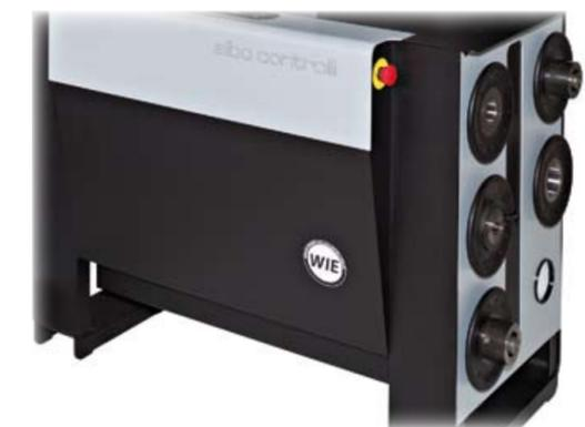
Molta attenzione è stata posta nello studio della struttura macchina e nel dimensionamento della base, totalmente realizzata in acciaio da costruzione, saldata sia a TIG, sia a filo continuo. Tale progetto assicura a tutta la macchina una particolare rigidità, con conseguente garanzia di alta precisione e indeformabilità.
