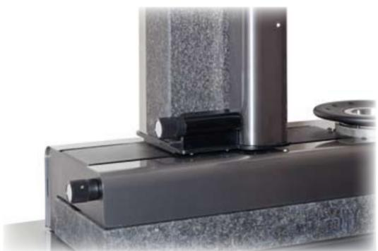
Registrazione micrometrica degli assi X e Z con due volanti. Indispensabili per collimare la misura sia su target fisso che in autocollimazione.
