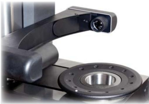
Sistema telecamera per le misure e l'ispezione. Sensore C-MOS, doppio illuminatore a luce rossa puntiforme e toroidale. Ottiche telecentriche a basso F/Number.
