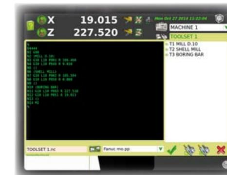
I dati vengono elaborati e post-processati dal software. Sono presenti più di 50 formati di post-processor per i controlli numerici più comuni nel mercato delle macchine utensili.
