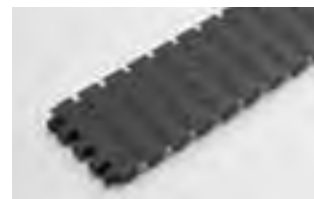
SERIE 1000 FLAT TOP • Azionamento centrale/a cerniera • Closed Hinge • Passo di 0,60 poll. (15,2 mm) • Larghezze disponibili: 1,1 poll. (29 mm), 1,5 poll. (37 mm), 1,8 poll. (46 mm) e 2,2 poll. (55 mm)
