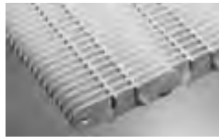
SERIE 400 • Azionamento centrale • Open Hinge • Passo di 2,00 poll. (50,8 mm) • Bordo sfalsato
