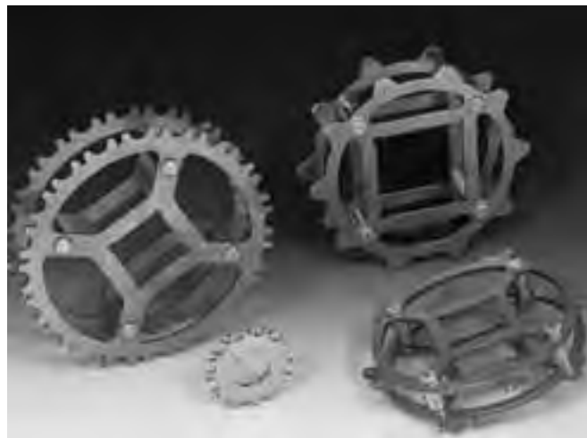
Fig. 2-28 Pignoni resistenti all'abrasione (interamente in acciaio)
