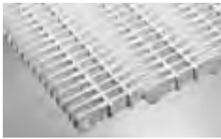
SERIE 200 • Azionamento a cerniera • Open Hinge • Passo di 2,00 poll. (50,8 mm) • Bordo sfalsato
