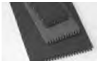
SERIE 900 FLAT TOP (85 mm) • Azionamento centrale • Closed Hinge • Passo di 1,07 poll. (27,2 mm) • Larghezze disponibili: 3,25 poll. (83 mm), 4,5 poll. (114 mm) e 7,5 poll. (191 mm)
