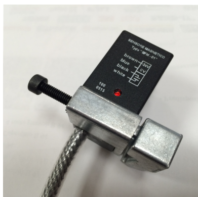
SFM-01 sensore magnetoresistivo ad alta sensibilità SFM-01 high sensitivity magnetoresistive sensor
