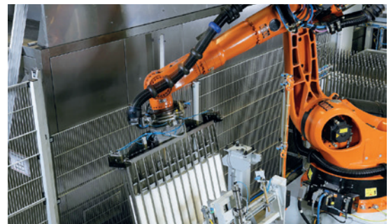
Sistemi di pinze per vasetti di yogurt (diversi diametri) / rimozione dalla macchina termoformatrice e confezionamento in cartoni
