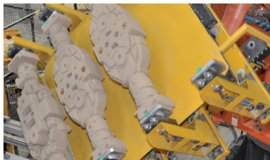
Sistema di pinze e di montaggio per anime di sabbia / prelievo dalla macchina sabbia /
