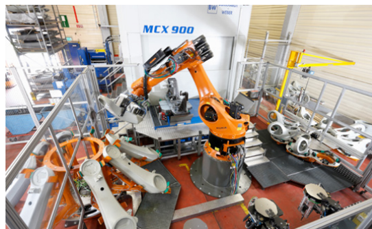
Sistemi di pinze incl. cambioutensile per pezzi colati e mandrino di sbavatura / carico e scarico centro di lavorazione
