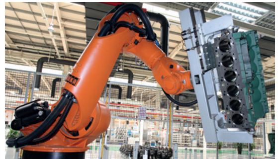
Sistema di pinze per basamento motore (600 kg)/ carico e scarico di stazioni di montaggio
