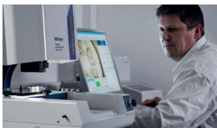
Strumento di misura ottico per la determinazione dimensionale delle dimensioni di controllo dei vostri componenti.
