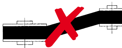
Spostamento assiale delle pulegge
