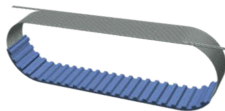
Struttura della cinghia dentata optibelt ALPHA FLEX con trefolo S+Z avvolto in modo elicoidale e poliuretano estruso sagomato
